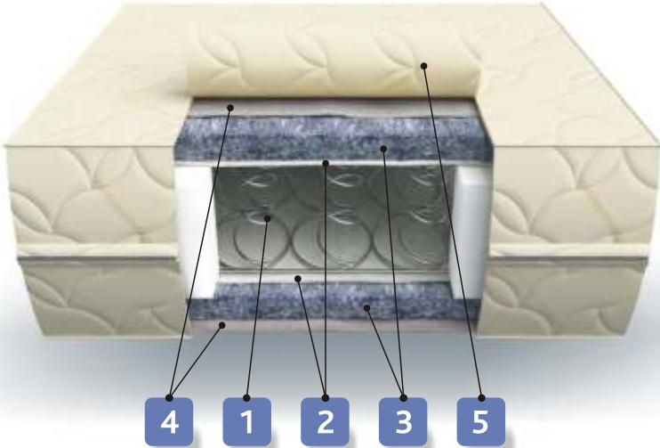
1. Блок пружин «Боннель» (четыреххвитковые пружины со смещенным центром опоры, высотой 60 мм, плотностью 118 шт/м<sup>2</sup>).
